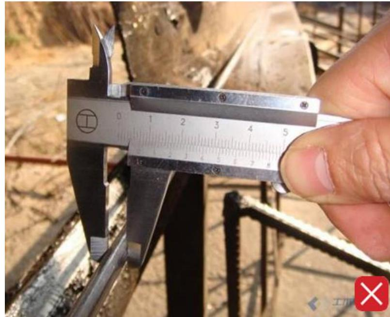
瘦身钢筋：8mm钢筋直径实测7mm。
