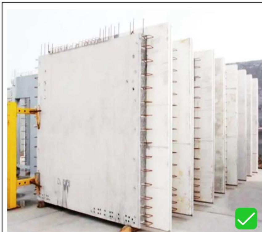
1. 装配式构件表面无气泡、夹渣及开裂。
